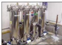
Завод металлической отделки установил несколько фильтров Hurricane® с 0.35- и 1-микронными картриджами, чтобы снизить уровень цинка в их сточных водах. После установки фирмой данных фильтров были соблюдены экологические требование и получено письменное разрешение.
